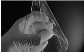
**Figure 4.** Flexible PDMS substrate.
