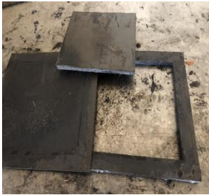
Fig. 2. Hard composite mould, (20 X 20) cm
